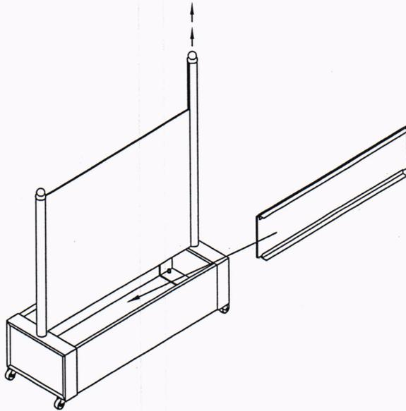
Auf einer Seite des Flower-Line-Kasten muss zuerst die Dichtung abgezogen werden um anschließend den Pfosten aus dem Kasten herausziehen zu können.
