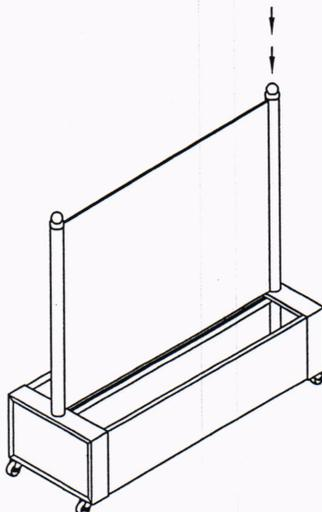
Nachdem die Trennwand positioniert wurde, kann der Pfosten abgelassen werden und die Dichtung eingezogen werden.
