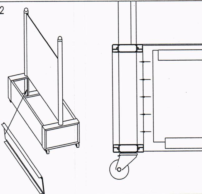
Die Trennwand kann jetzt in den Kasten eingesetzt werden. Hierbei ist darauf zu achten, dass die Trennwand in den Pfosten eingeführt werden muss.
