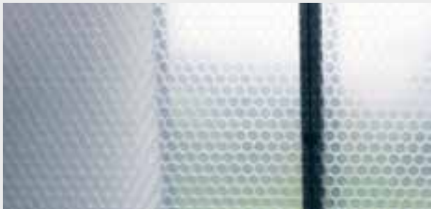
Luftpolster-Isolierfolie (Noppenfolie) 3-schichtige Isolierfolie mit Luftpolstern. (Die Klebeelemente werden mit Silikon einmalig an die Sprossen geklebt)
