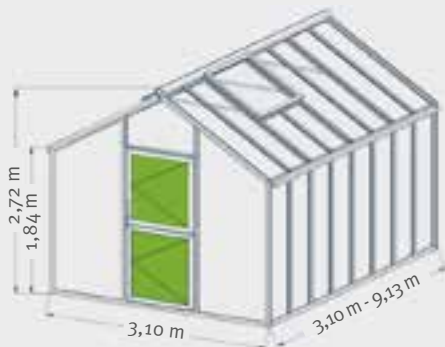
Bio-top III t-line mit 0,50 m Verglasungsraster
