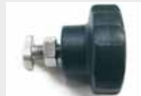
Befestigungselemente / Rändelmuttern Folienhalter mit Patent-Hammerkopfschraube und Mutter aus Edelstahl. Folie wird aufgesteckt und durch die Rändelmutter gehalten. Ohne zu kleben (eine einfache Lösung), auch für Fremdfabrikate mit passenden Profilenuten.
